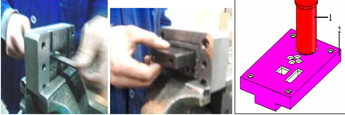
Resim 2.1: Kesme zımbalarının kılavuz plakaya alıştırılması
