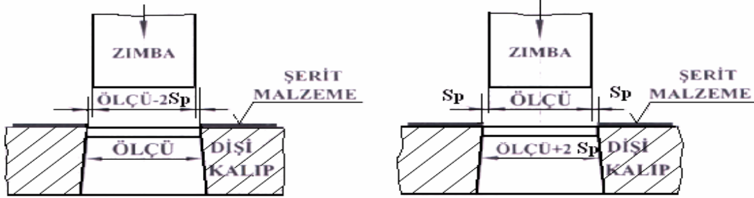
Resim 2.5: Kesme boşluklarının verilmesi
