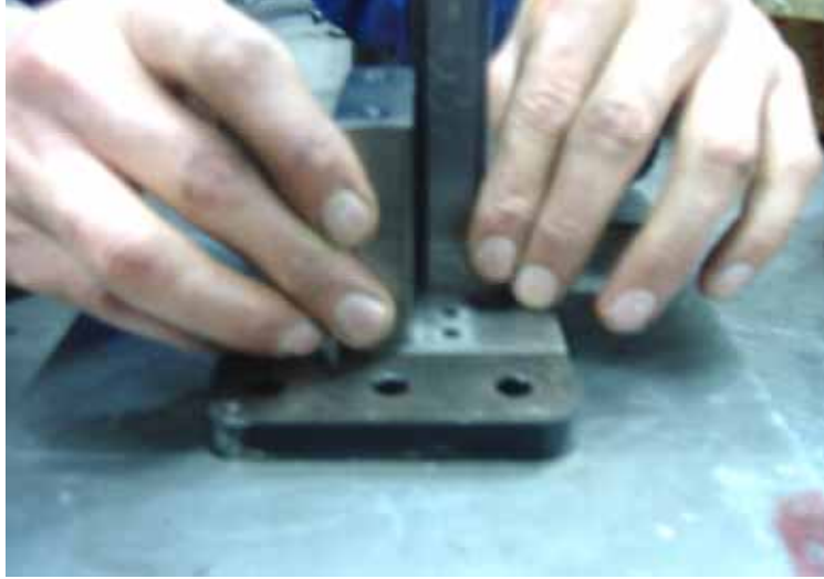
Resim 2.12: Alıştırma işlemlerinde gönye ile diklik kontrolü
