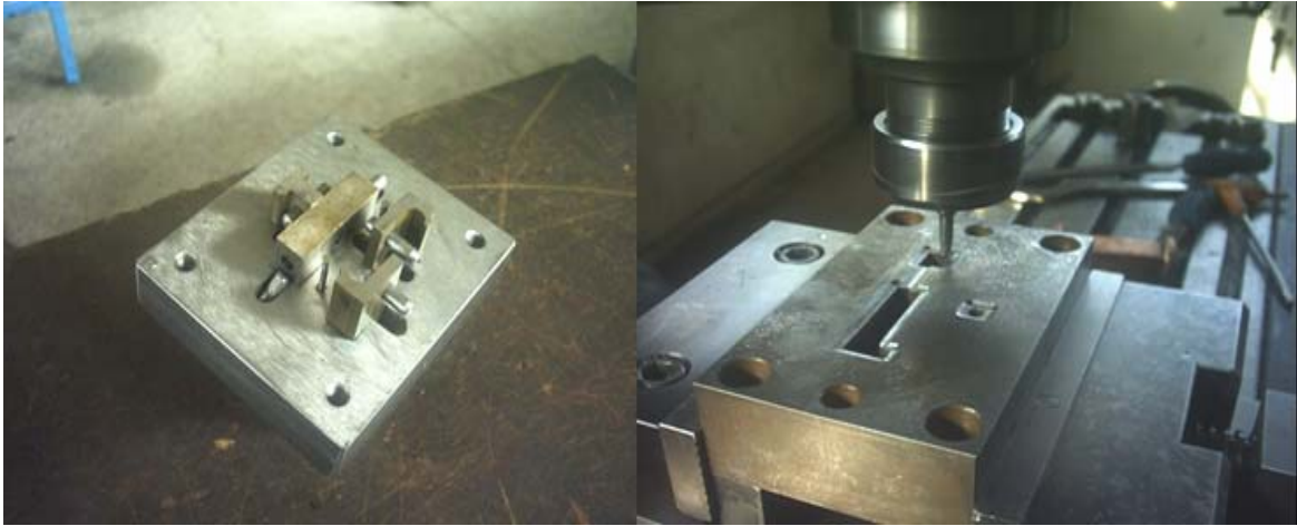
Resim 2.9: Zımba tutucunun pim kanalları açılarak işlenmesi ve zımbaların montajı, zımba tutucunun işlenmesi
