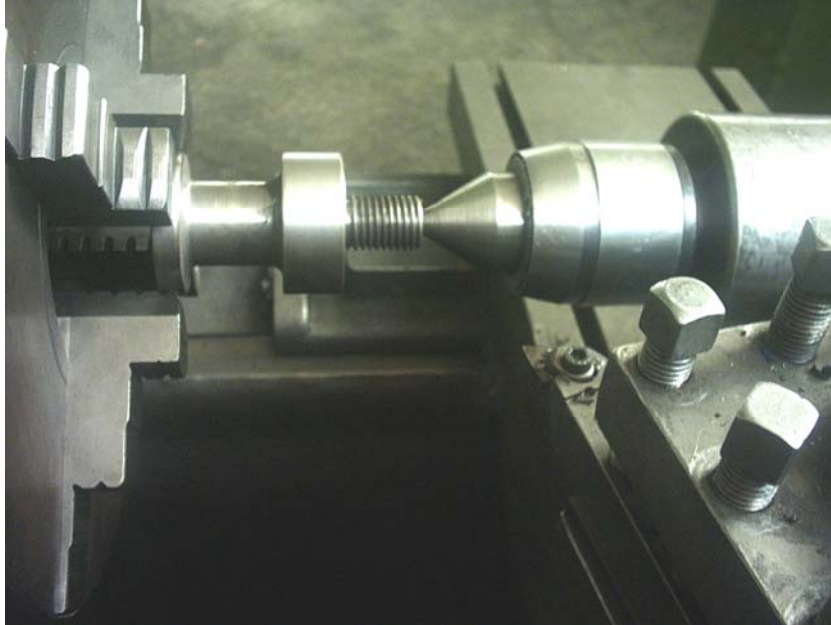
Resim 2.11: Kalıp bağlama sapının torna tezgâhında işlenmesi
