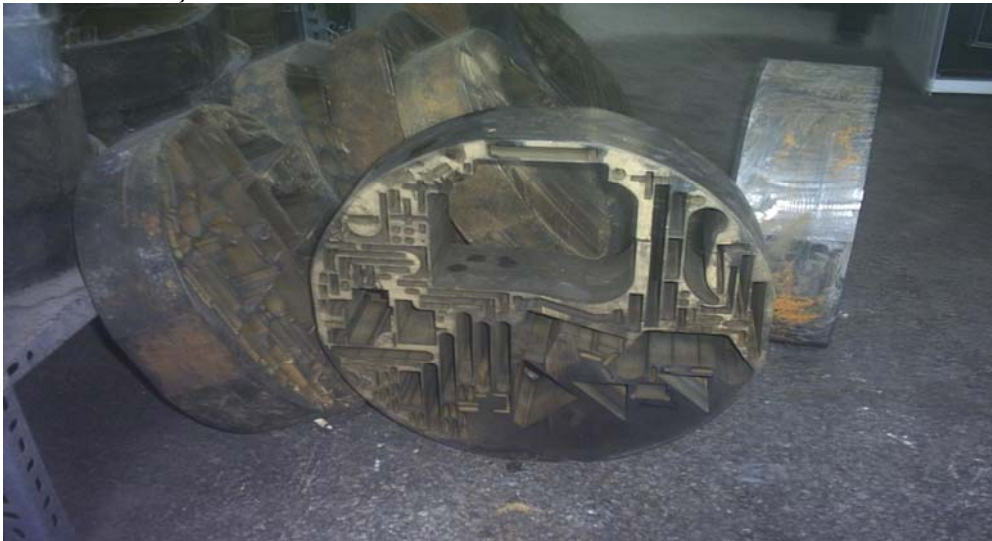
Resim 2.7: Tel erezyonda, içinden delme kesme zımbası çıkarılmış, sertleştirilmiş takım çeliği kütüğü
