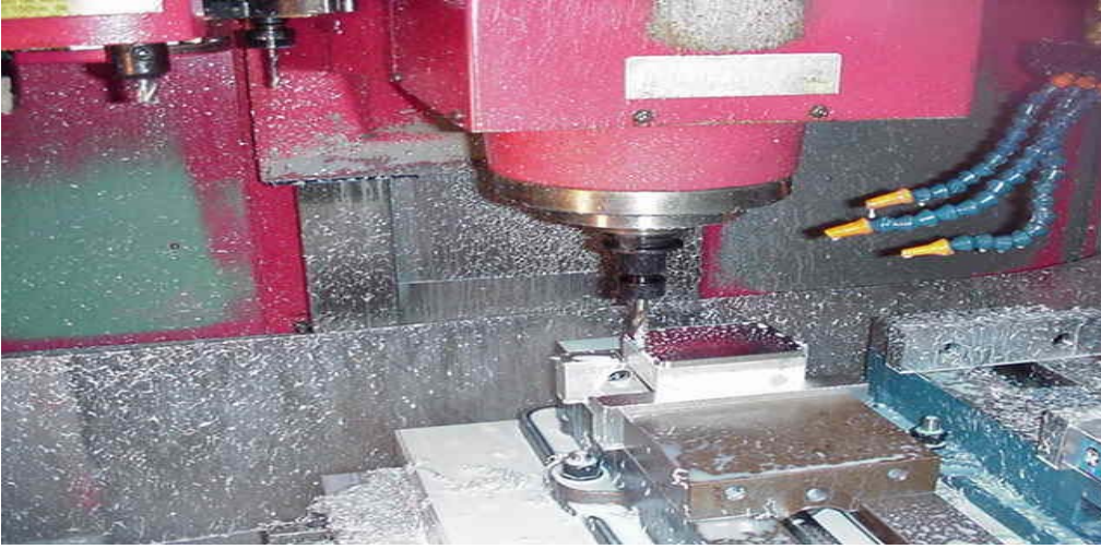
Resim 2.5: İş parçasının CNC freze (dik işleme) makinesinde işlenmesi
