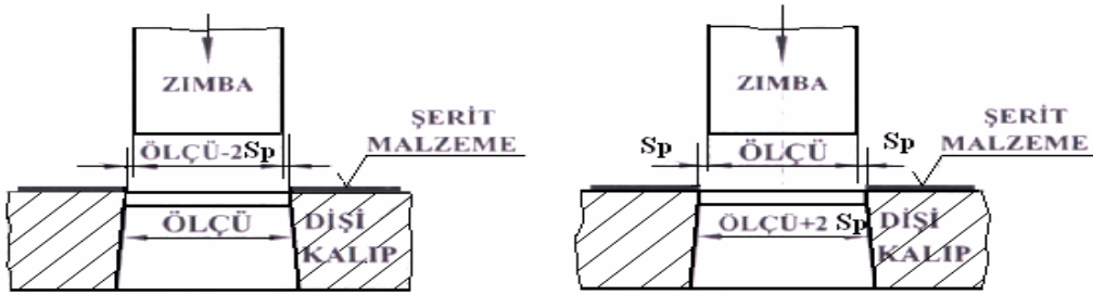
Resim1.39: Kesme boşluğunun erkek veya dişiye verilmesi
