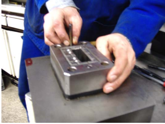
Resim 2.2: Kılavuz plakaya merkezleme pimlerinin takılması
