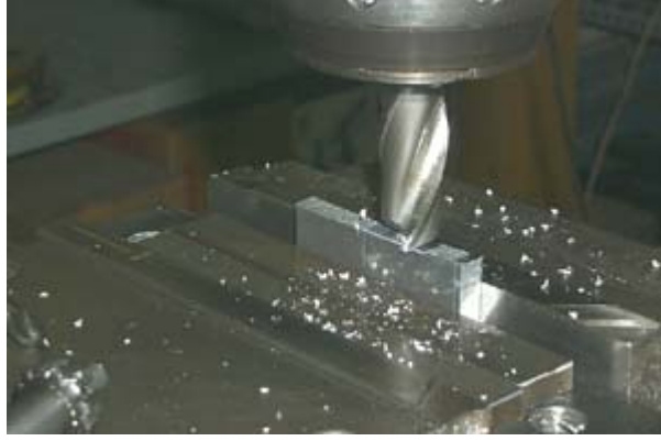
Resim 1.11: Dayamaların üniversal tezgahta yapılması
