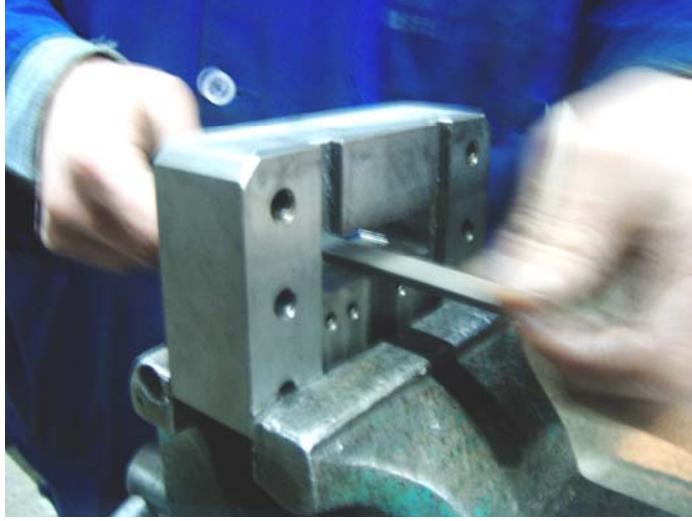
Resim 2.4: Eğe ile, kılavuz plakadaki kesme zımbası yuvasının düzeltilmesi
