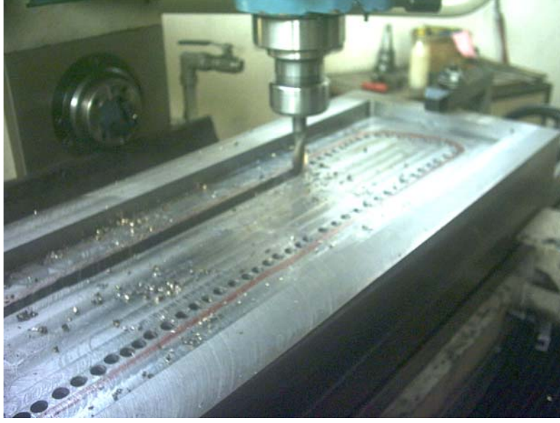
Resim 1.12: Üniversal tezgahta çürütme işlemi
