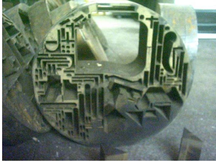
Resim 1.10: Zimbaların tel erozyonla kütükten kesilmesi
