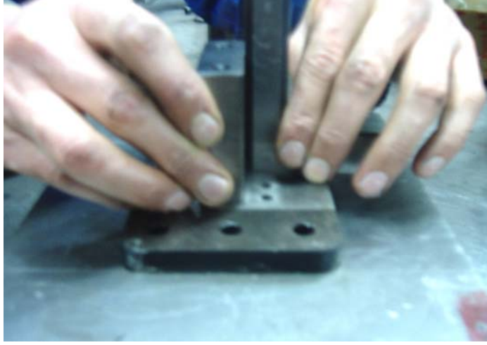
Resim 2.12: Alıştırma işlemlerinde gönye ile diklik kontrolü
