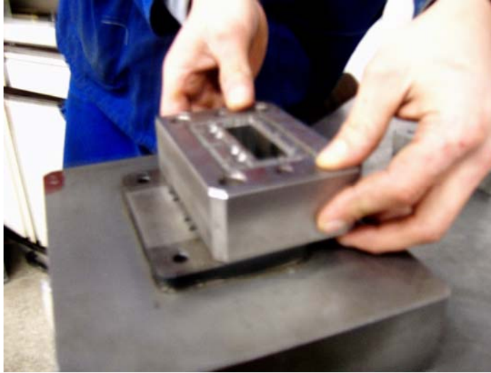
Resim 2.1:Alt plakaya monte edilmiş dişi plaka ve üzerine kılavuz plakanın yerleştirilmesi
