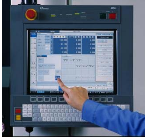
Resim 1.4: Dokunmatik ekranlı Makino kontrol ünitesi
