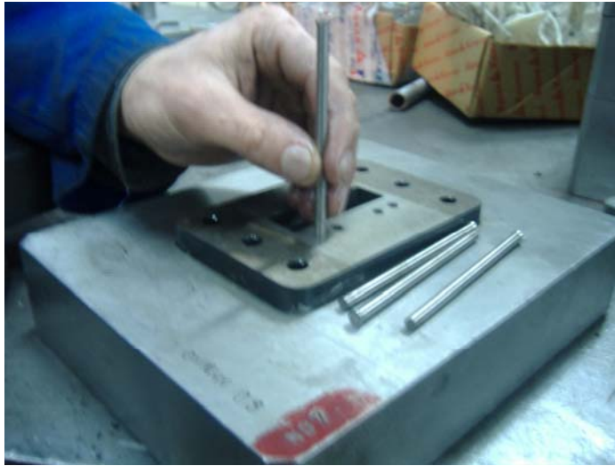
Resim 2.10: Delme zımbalarının kesme boşluğu
