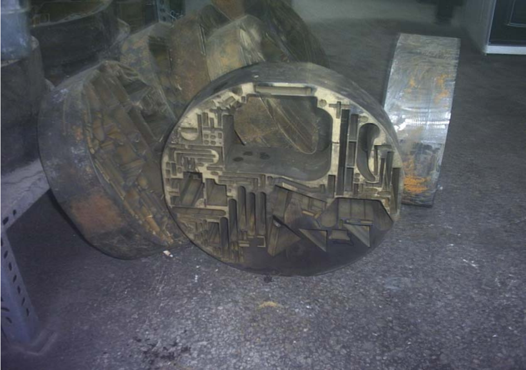
Resim 2.8: Tel erezyonda, içinden delme kesme zimbası çıkarılmış, sertleştirilmiş takım çeliği kütüğü
