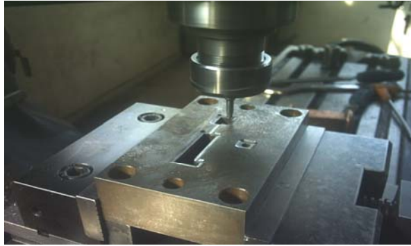
Resim 2.10: Zımba tutucunun işlenmesi
