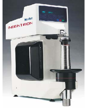
Resim 1.9: Rockwell sertlik ölçüm cihazı
