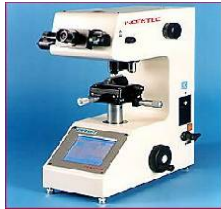
Resim 1.8: Vickers sertlik ölçümü ve sertlik ölçüm cihazı
