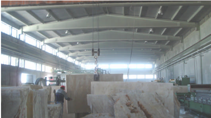
Resim 2.7: Katrakta kesilmiş plakaların vinç yardımı ile istiflenmesi
