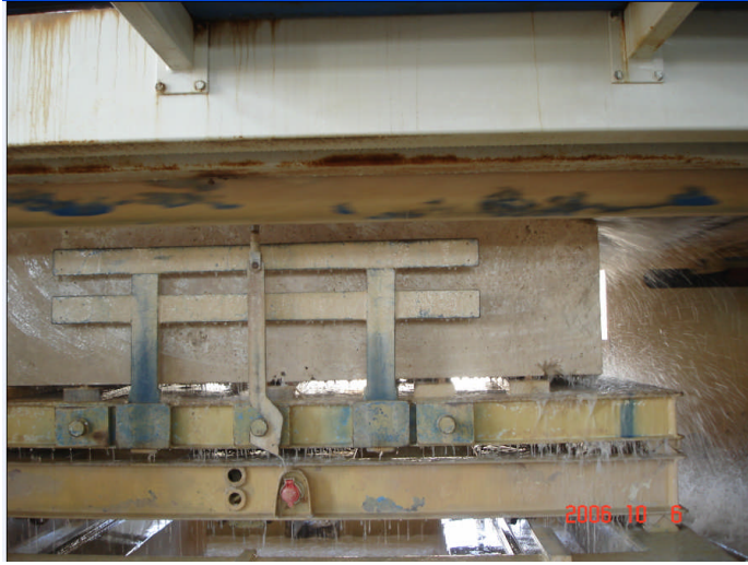
Resim 2.2: Trasfer arabası ve vagon yardımıyla blok yüklemesi ve sabitlemesi
