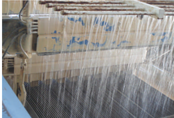
Resim 2.4: Yeni tip katraklarda kamalama işlemi
