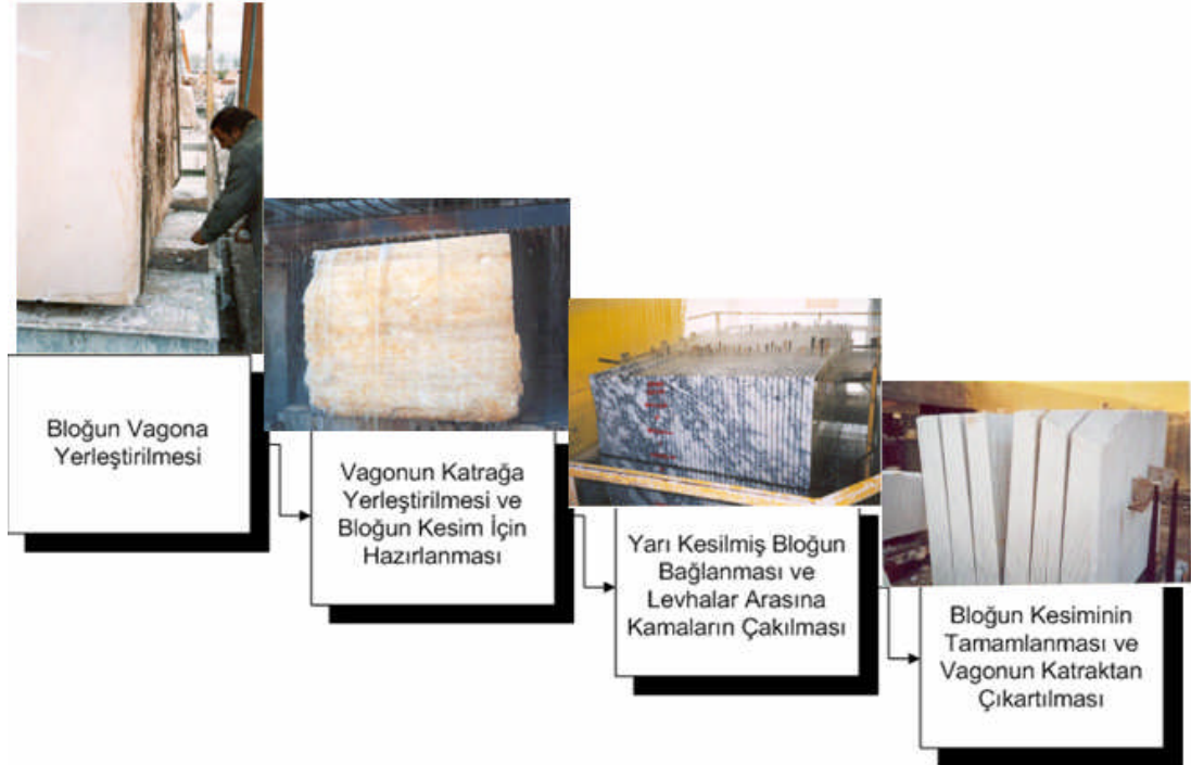
Resim 2.1: Katrakta plaka kesim aşamaları
