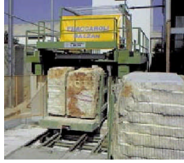
Resim 1.8: Vagon üzerine yüklenmiş blokların makineye ilerletilmesi
