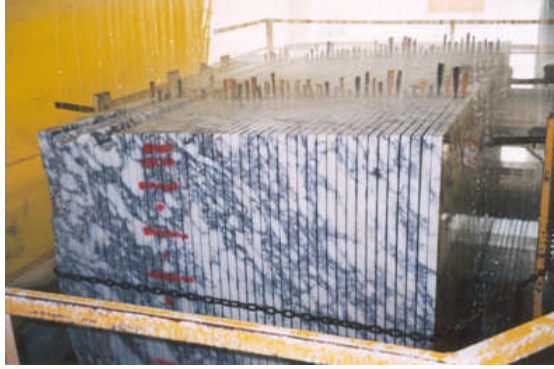
Resim 2.5: Yarı kesilmiş plakaların etrafının zincirle sabitlenmesi
