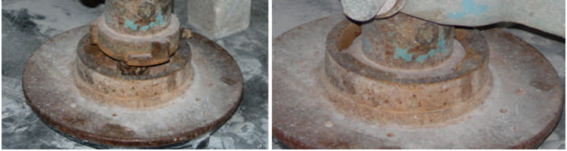
Resim 2.13: Aşındırıcı pleytinin başlığa bağlanması
