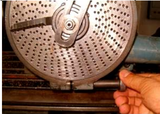
Resim 1.1. Sıkma vidasının gösterilmesi
