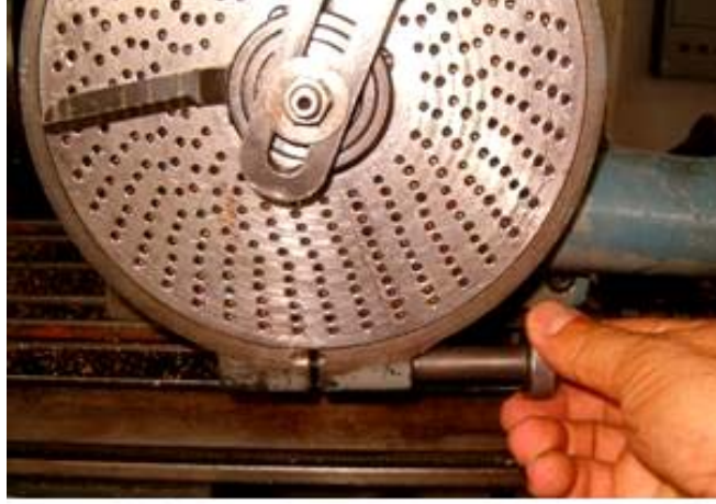
Resim 1.2: Tespit vidasının gösterilmesi
