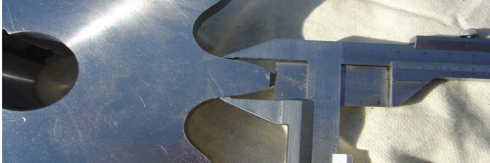
Resim 2.5: Modül kumpası ile diş kontrolü
