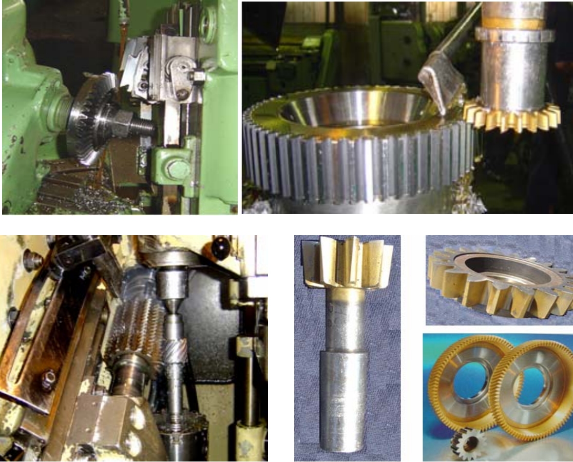
Resim 2.2: Değişik metotlarla dişli açma yöntemleri
