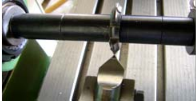
Resim 1.3: İş ekseninin freze eksenine ayarlanması
