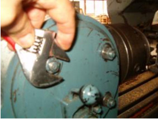
Resim 2.4: Açılacak konik dişli için aç verilmesi
