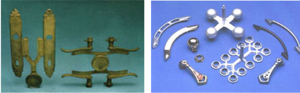
Resim 1.6: Metal enjeksiyon kalıpları ile üretilen ürün ve yolluklar
