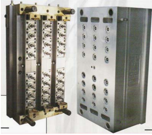
Resim 1.3: Şişirme kalıbı 1. operasyon kalıbı ve ürünü
