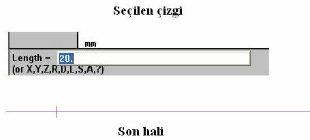
Şekil 1.15: Nokta-Length komutu istenen mesafeye nokta yerleştirme
