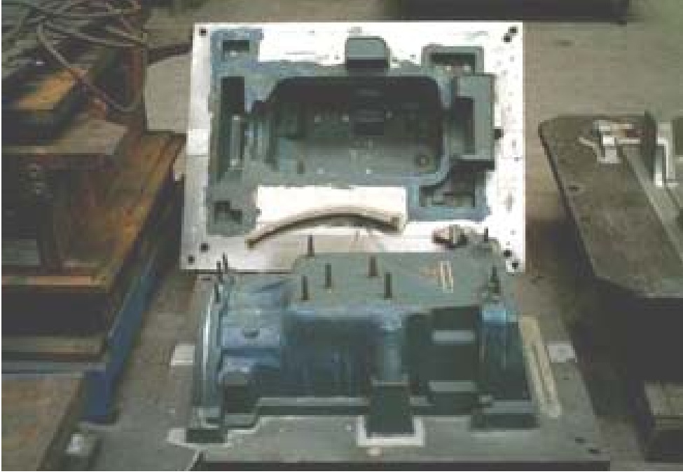
Resim 2. 4 : Epoksi modelleme ile hazırlanan model ve negatifi
