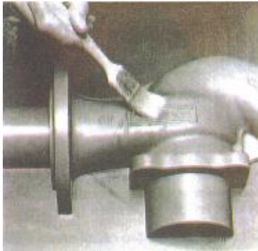
Resim 3.1: Kalıp ayırıcı uygulaması
