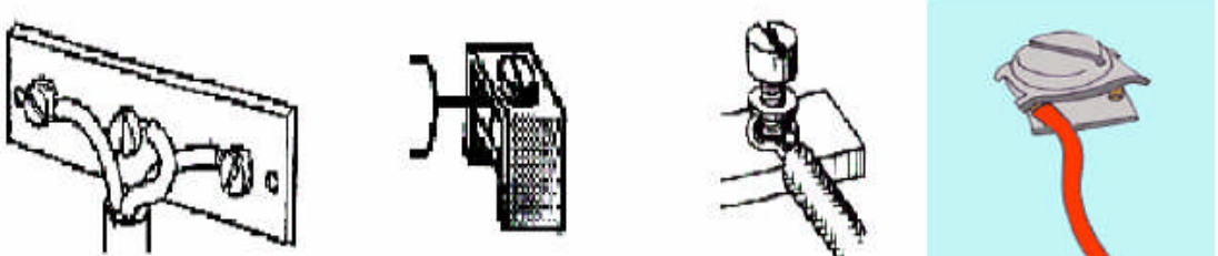
Resim 1.11: İletkenlerin terminallere bağlanması
