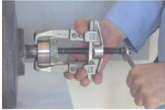
Resim 2.28: Dişlinin çekirme ile sökülmesi
