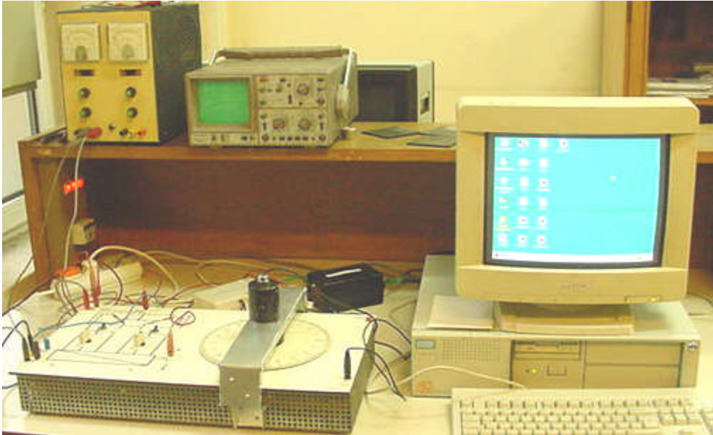
Resim 2.13: Adım motorun bilgisayarla kontrolü
