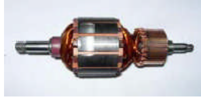
Resim 2.9: Endüvi mili üzerine yerleşmiş kollektör
