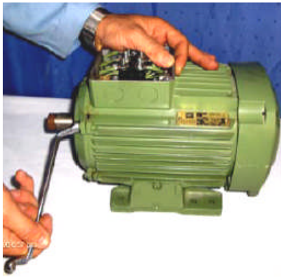
Resim 2.29: a-) Motor kapak civatalarının sökülmesi
