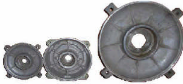
Resim 2.19: Asenkron motorun kapakları
