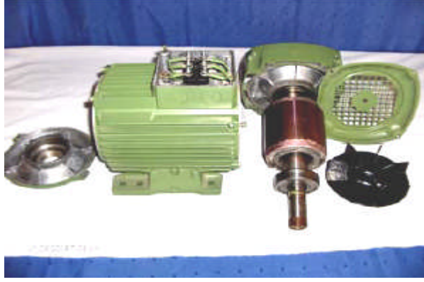
Resim 2.30: Motorun parçaları çıkarılmış hali
