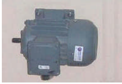
Resim 2.1: Bir fazlı asenkron motor
