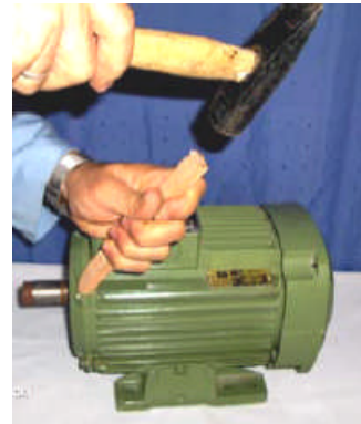
b-) Kapaklarının sökülmesi
