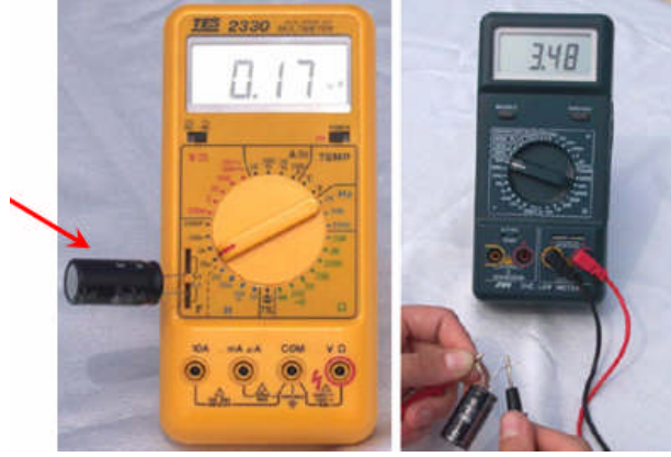
Resim 1. 5: Dijital ölçü aleti ile kondansatör kapasite değeri ölçümü
