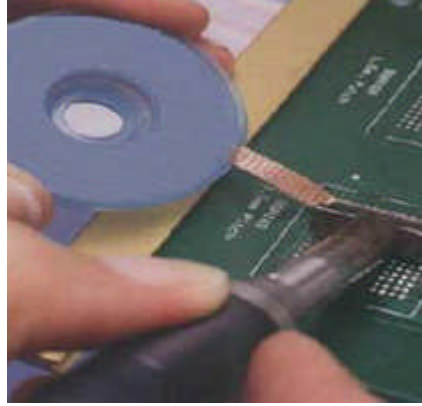
Resim 1.20: Lehim emme fitili ile lehim sökme işlemi
