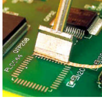
Resim 1.18: Çeşitli entegre lehimleme işlemleri
