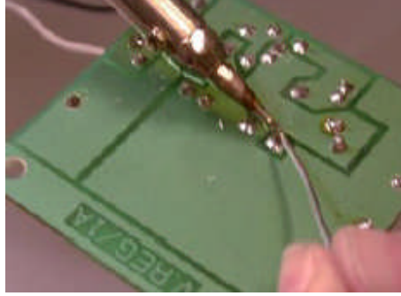
Resim 1.15: Elektronik devre elemanlarının baskı devre plaketine lehimlenmesi
