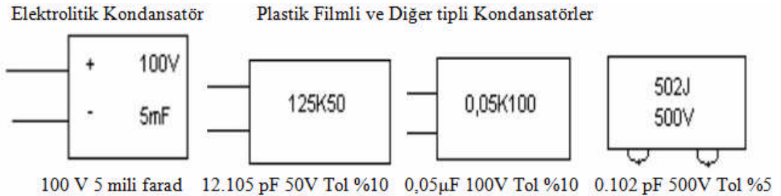
Şekil 2.19: Değeri üzerinde verilen kondansatörler
