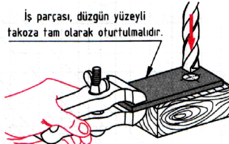
Şekil 2.7: Takoz üzerinde serbest elle delme usulü
