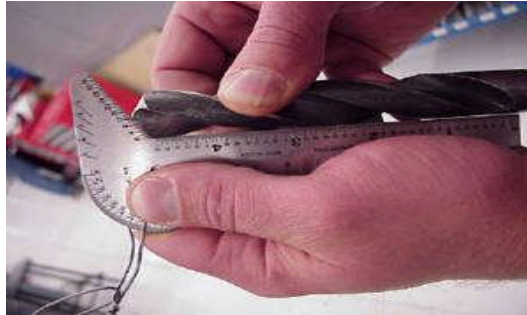
Resim 1.3: Sabit açı gönyeleri ile bilen matkap kontrolü
