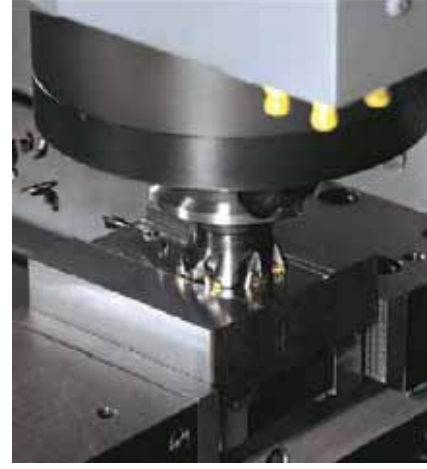
Şekil 1.41: Freze tezgâhında kalıp gövdesinin işlenmesi
