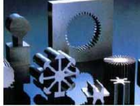
Şekil 1.40: Tel Erozyon tezgâhında kesilmiş örnek parçalar
