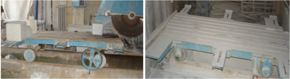
Resim 1.24: Raylar, tabla ve hareket sistemi
