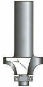
Resim 2.4 Freze çakısı ve profili
