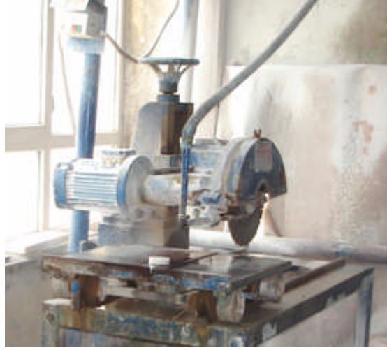
Resim 1.9: Tablası hareketli olan baş kesme makinesi
