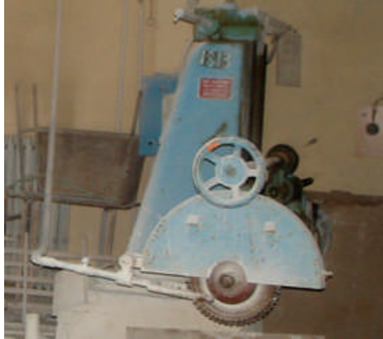
Resim 2.2: Makineye profil testeresi bağlanması
