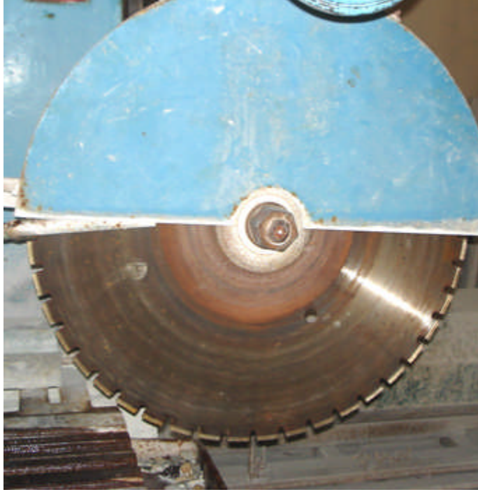
Resim 1.17: Flanşla testerenin bağlanması
