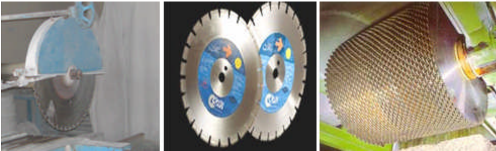
Resim 1.14:Başlığa takılmış dairesel testere
