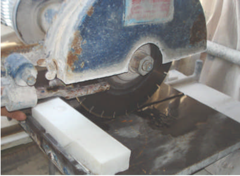
Resim 1.19: Baş kesme makinesinde kesme işlemi
