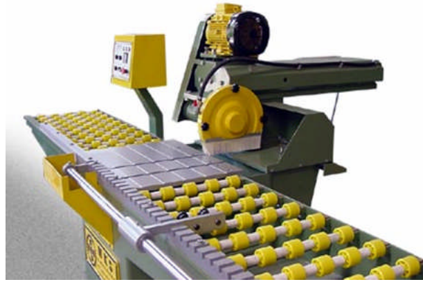
Resim 1.8:Başlı hareketli baş kesme makinesi
