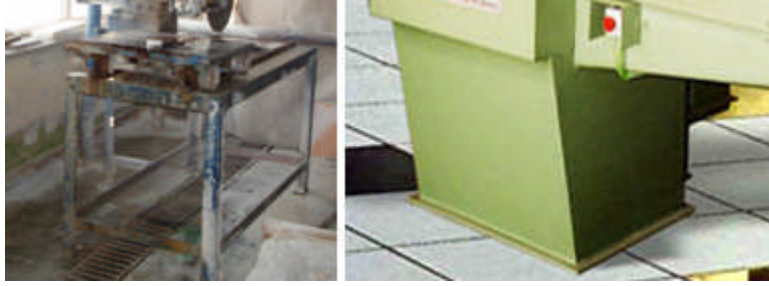
Resim 1.11: Çelik konstrüksiyon ve dökme demirden gövdeler
