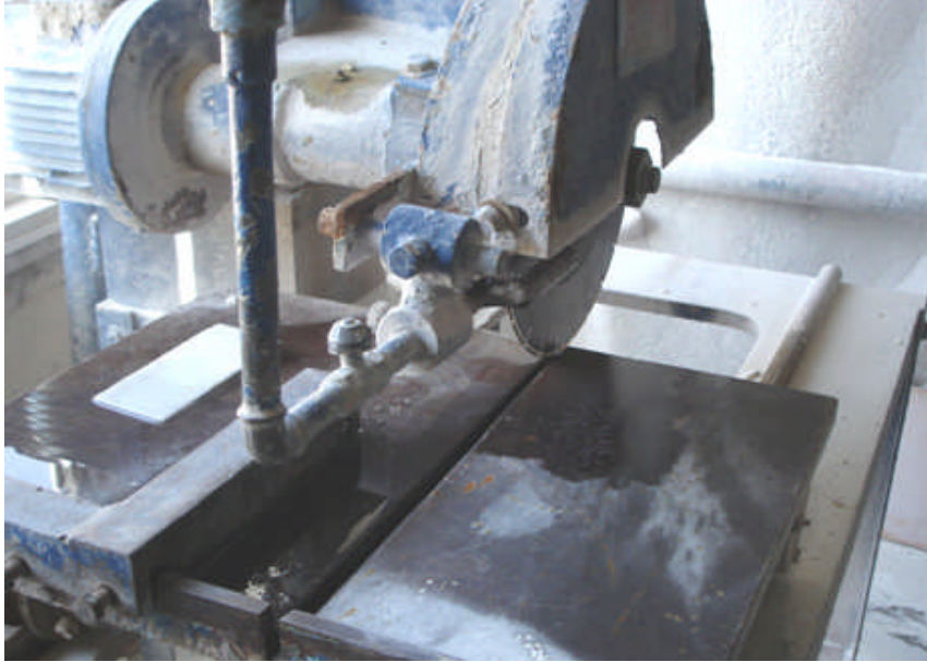
Resim 1.18:Baş kesme tezgâhı tablası
