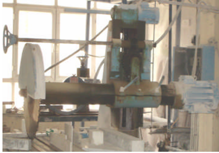
Resim 1.23: Gövde ve başlık hareket sistemi
