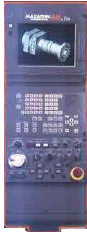
Resim 1.5: Mazatrol kontrol paneli
