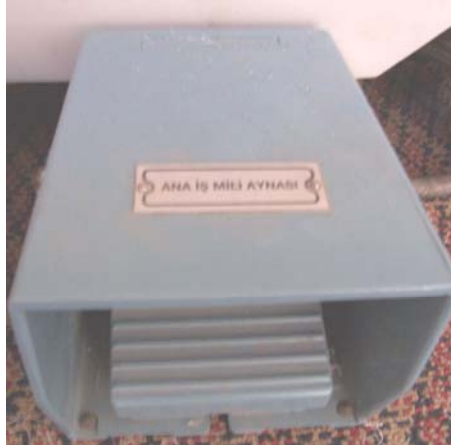
Resim 1.8: Ayna ayaklarını kapatma-açma pedalı
