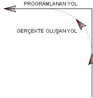
Şekil 1.1: G04 komutu ile eksendeki hareketler
