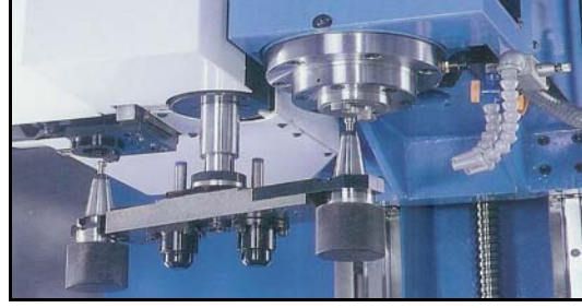
Şekil 3.3: Bir CNC tezgahında kesici takımın otomatik deęiştirilmesi
