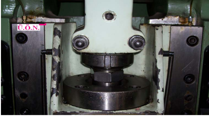
Resim 2.2: Koç başlığı üst ölü noktada
