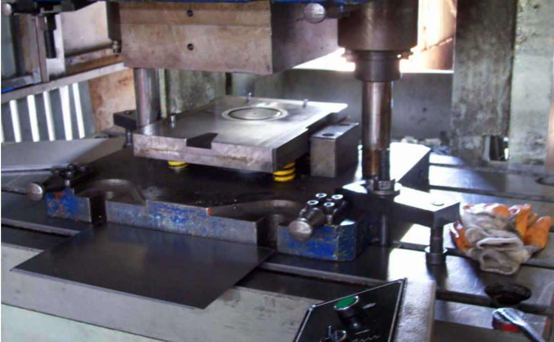
Resim 2.5: Parça basmaya hazırlanmış kalıp
