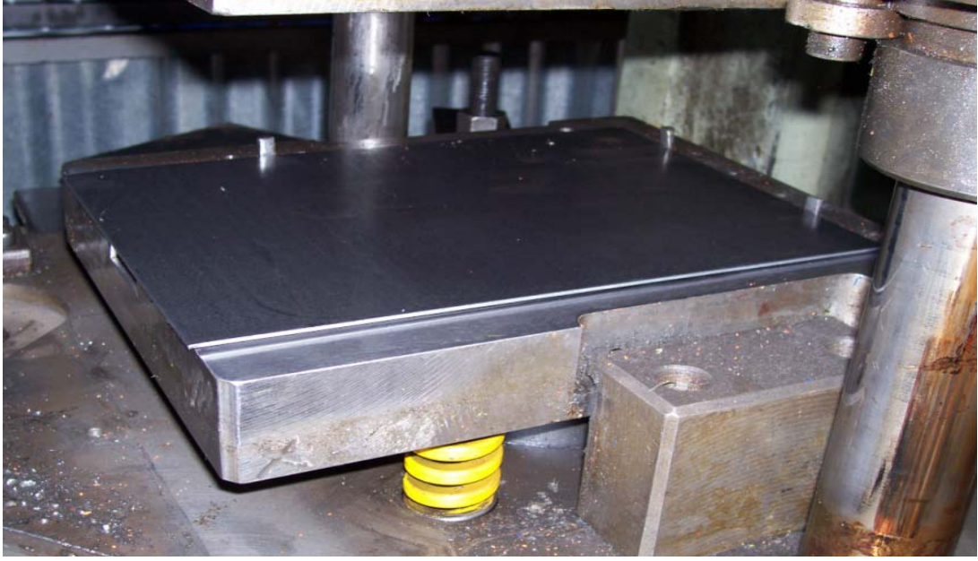
Resim 2.6: İlkel parçanın kalba yerleştirilmesi
