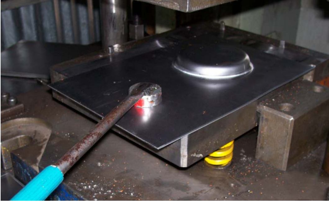
Resim 2.8: Üretilen parçanın manyetik tutucu ile kalıptan alınması
