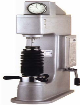
Şekil 1.32: Rockwell sertlik ölçme cihazı, mekanik
