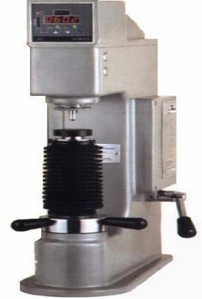
Şekil 1.33: Rockwell sertlik ölçme cihazı dijital
