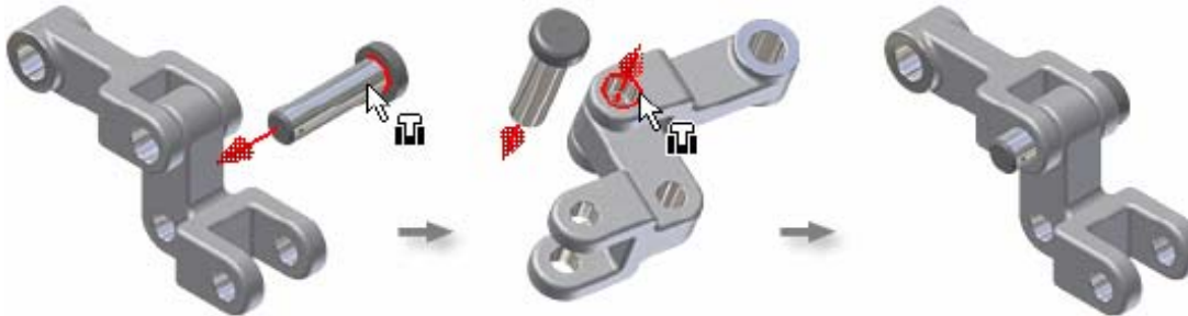
Şekil 2.189: Insert (yerleştirme) sınırlaması ve seçenekleri
