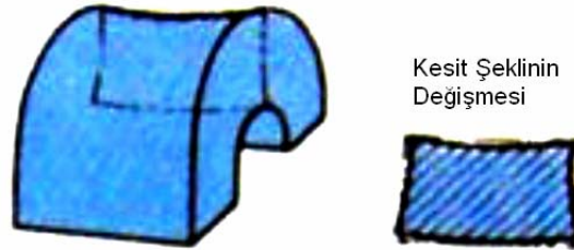
Şekil 1.5: Bükme işlemi esnasında kesit değişimi
