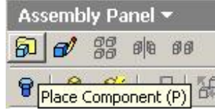
Şekil 2.168: Place component komutunun çalıştırılması
