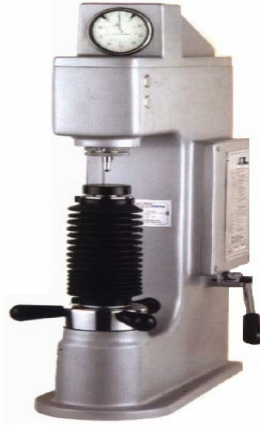
Şekil 1.42: Rockwell sertlik ölçüm cihazı mekanik
