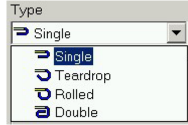
Şekil 2.96: Kenet bükme işlem seçenekleri
