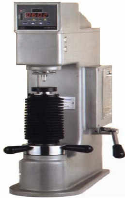
Şekil 1.42: Rockwell sertlik ölçüm cihazı dijital
