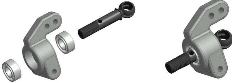
Şekil 2.176: Montajda parçaların ilişkilendirilmesi ve montajın tamamlanması
