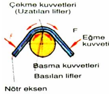
Şekil 1.3: Uzama ve basma gerilimleri
