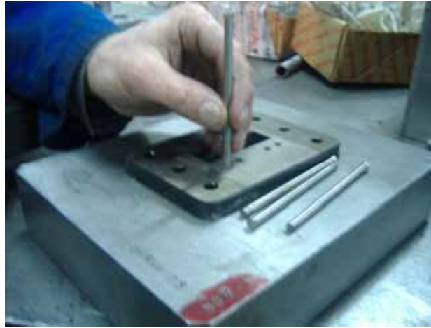
Resim 2.8: Delme zımbalarının kesme boşluğu
