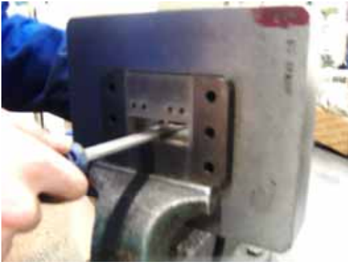
Resim 2.3: Dişi plakanın eğe ile düzeltilmesi
