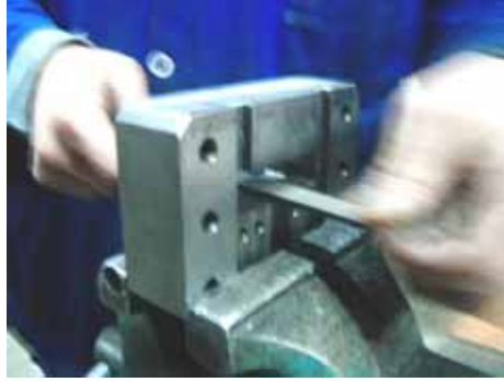
Resim 2.2: Eğe ile kılavuz plakadaki kesme zımbası yuvasının düzeltilmesi
