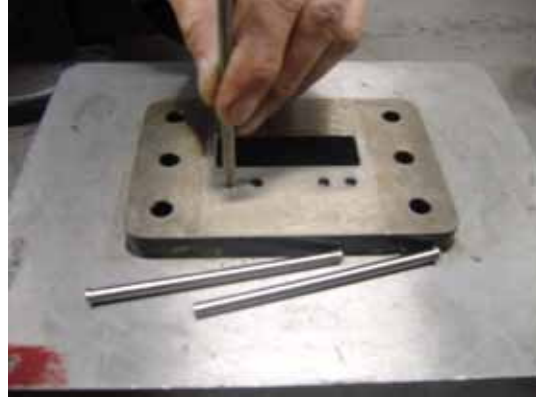
Resim 2.6: Delme zımbalarının dişi plakaya alıştırılması
