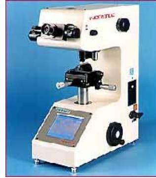
Resim 1.5: Vickers sertlik ölçümü ve sertlik ölçüm cihazı
