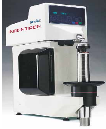
Resim 1.6:Rockwell sertlik ölçüm cihazı
