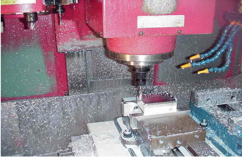
Şekil 1.39. İş parçasının CNC Freze (dik işleme) makinesinde işlenmesi
