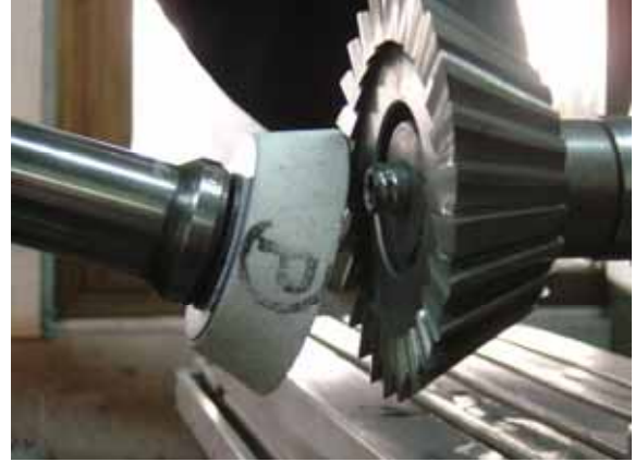
Resim 4.5: Bir açılı freze çakısının bilenışı ve ikinci boşluk açısının verilmesi
