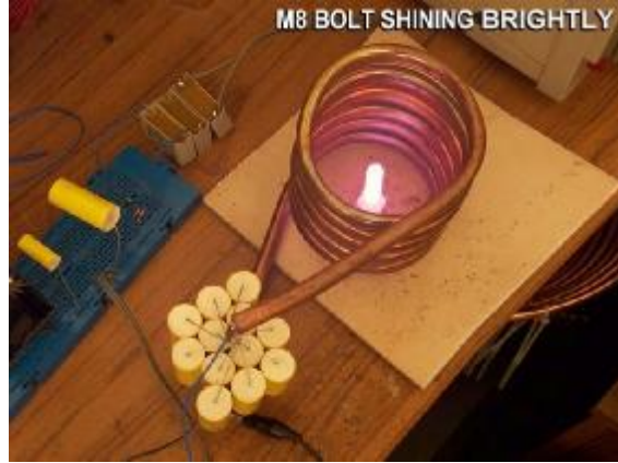
Resim 5.11: IGBT ile yapılan endüksiyonla ısıtma devresi
