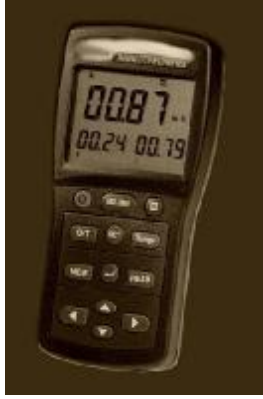
Şekil 4.5: Bazı manyetik alan ölçerler
