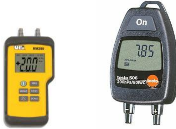
Şekil 5.6: Çeşitli basınç ölçerler
