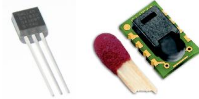
Şekil 1.6: Sayısal algılayıcı örnekleri
