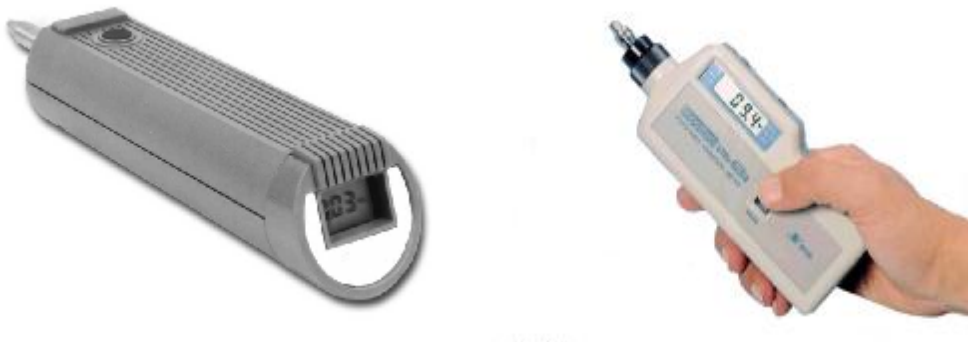
Şekil 1.17: Çeşitli titreşim ölçerler
