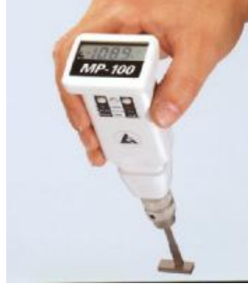
Şekil 4.5: Bazı manyetik alan ölçerler
