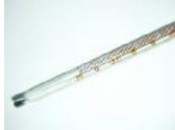
Şekil 1.2: Bir cıvalı termometre
