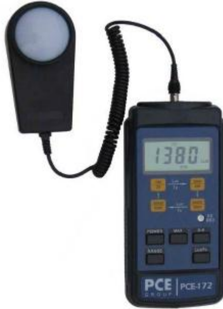
Şekil 1.21: Bir dijital lüksmetre
