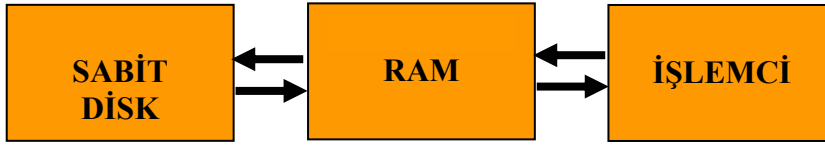
Şekil 1.1: Programların sabit diskten RAM'e ve oradan da işlemciye alınması. İşlemcinin ürettiği sonuçların RAM'e ve oradan da sabit diske alınması
