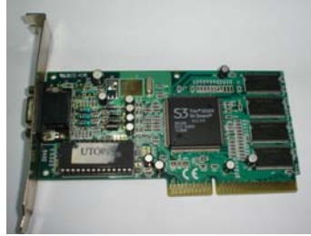
Resim 1.6: PCI veriyoluna takılan ekran kartı
