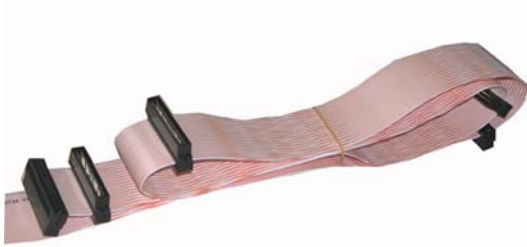
Şekil 1.23: 2'den fazla cihazın bağlanabildiği bir SCSI kablosu
