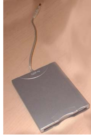
Şekil 2.4: USB arayüzlü harici 3,5" disket sürücüsü
