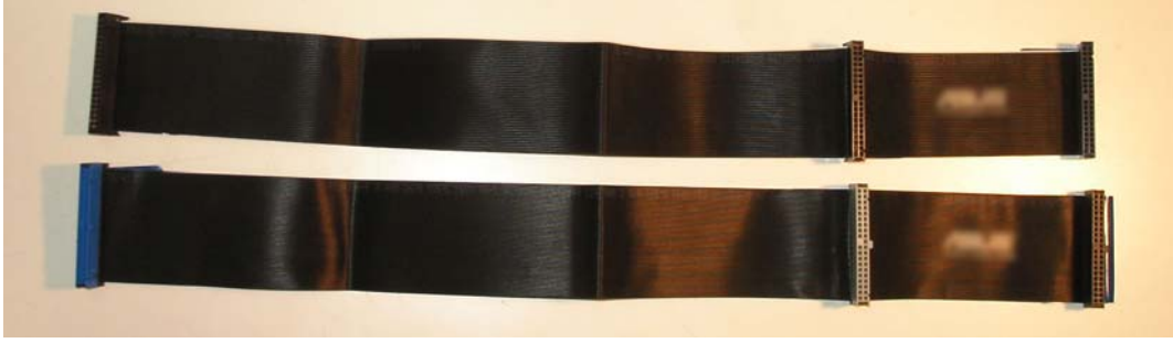
Şekil 1.15: 40 telli ve 80 telli paralel ATA kabloları
