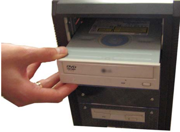
Şekil 3.16: Dahili IDE DVD sürücünün kasa içine montajı
