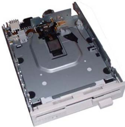
Şekil 2.7: Disket sürücünün iç görünüşü
