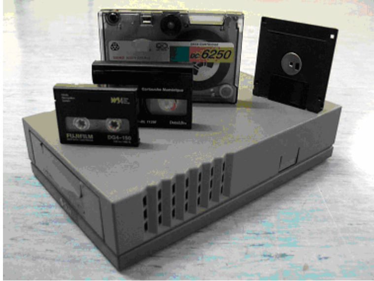
Şekil 2.14: Teyp sürücü ve çeşitli teyp kasetlerinin FDD disklerle karşılaştırılması
