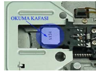
Şekil 2.8: Disket sürücünün okuma kafası
