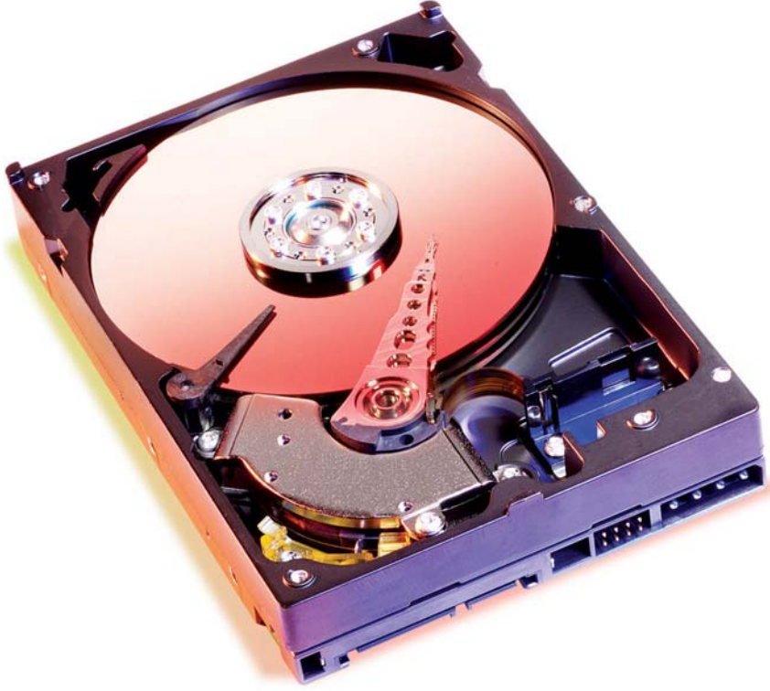
Şekil 1.38: Üzerinde iki tür güç girişi bulunan SATA sabit disk sürücüsü
