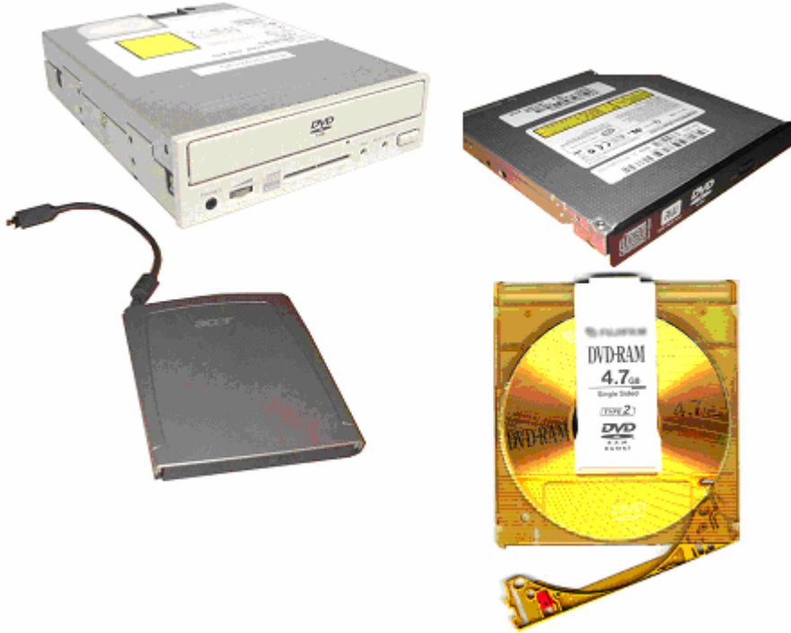
Şekil 3.1: Çeşitli optik sürücüler ve bir optik disk
