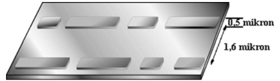
Şekil 3.3: CD-ROM'un yüzey yapısı
