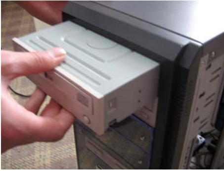
Şekil 3.26: İkinci optik sürücünün montajı
