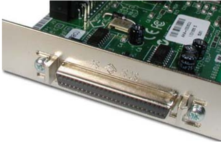
Şekil 1.24: SCSI-3 ve sonrasında kullanılmaya başlanan bir konektör tipi
