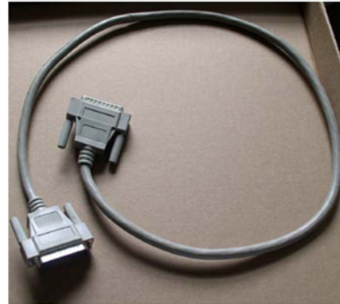
Şekil 1.28: Harici SCSI cihazları bağlamak için kullanılan kablolar
