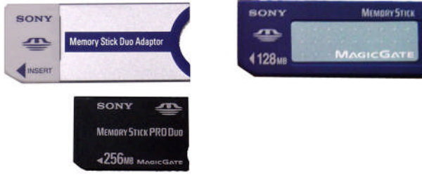
Şekil 1.59: Solda Memory Stick Duo kartı ve adaptörü, sağda ise Memory Stick kartı gösterilmiştir
