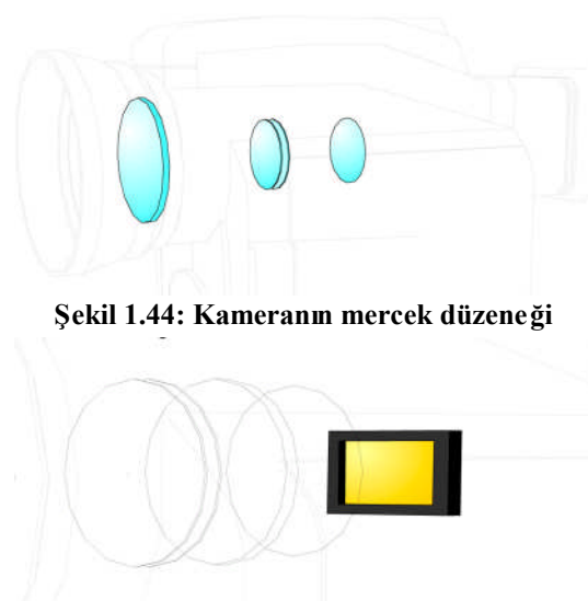
Şekil 1.46: Merceklerden geçen ışığın CCD yüzeyine çarpması
