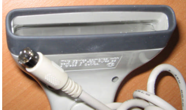
Şekil 2.18: Lazer barkod tarayıcı ve PS/2 bağlantı noktası
