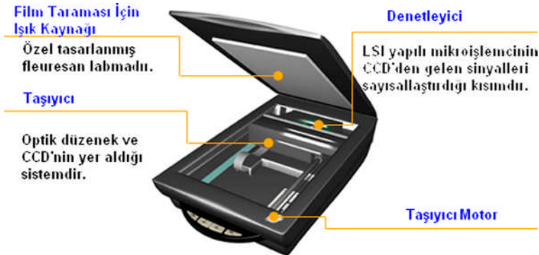
Şekil 2.3: Düzyataklı tarayıcının yapısı
