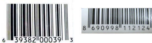
Şekil 2.16: Solda 12 rakamlık barkod, sağda 13 rakamlık barkod
