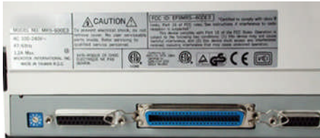
Şekil 2.14: Tarayıcı üzerinde birden fazla konektör olabilir
