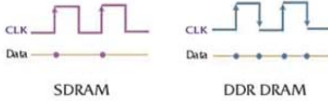
Şekil 1.9: SDRAM ve DDR DRAM arasındaki zaman farkı
