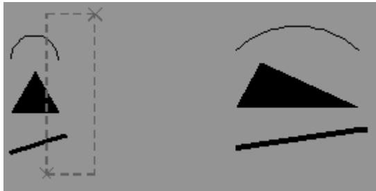
Şekil 1.60. Strehch Komutunun Kullanımı
