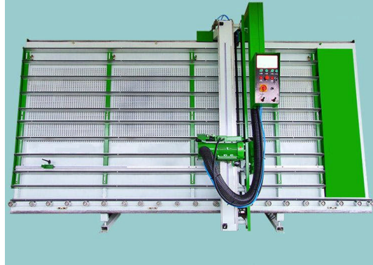
Resim 1.2: Testeresi sadece dikey doğrultuda hareket eden dikey ebatlama makinesi
