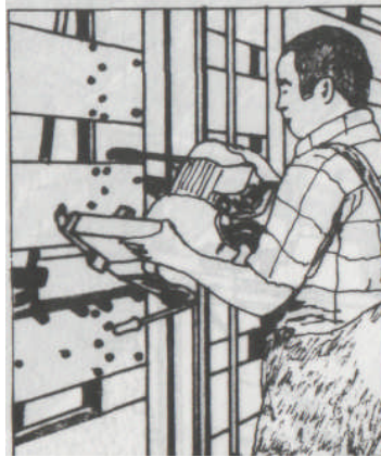
Şekil 1.1: Testereyi düşey pozisyonundan yatay pozisyona çevirmek
