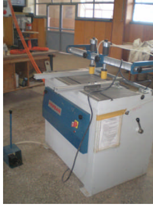
Resim 2.2: Çoklu delik makinesi gövde görünümü
