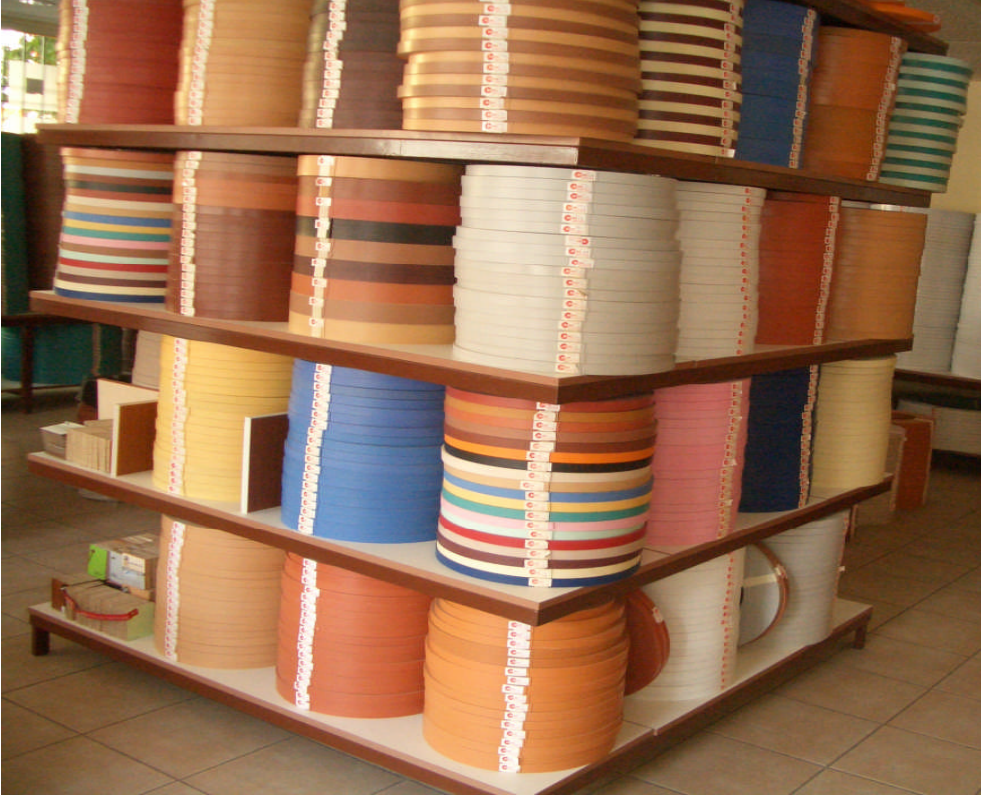
Resim 1. 3: Kenarlara yapıştırılan kenar bantları
