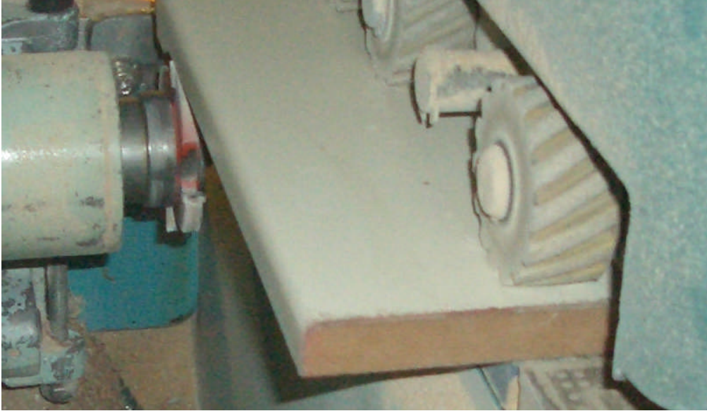
Resim 2. 12: Postforming de alt fazlalıkları temizleme
