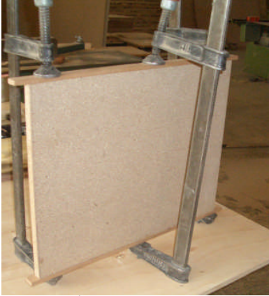
Resim 1.4: İşkence ile masif yapıştırma
