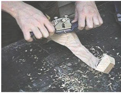
Resim 2.1: Çift yöne eğmeçli şablonla kesim yapmak
