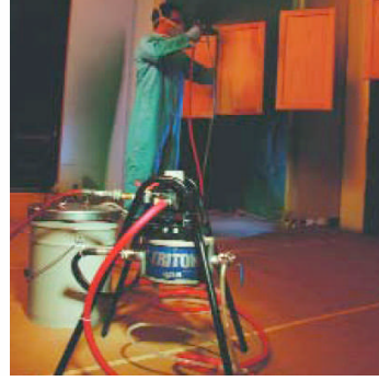
Resim 1.3: Elektrostatik püskürtme tabanca sistemi ve kullanılması
