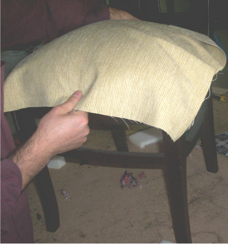
Resim 2.1: Döşemeye yüz gereci yerleştirme
