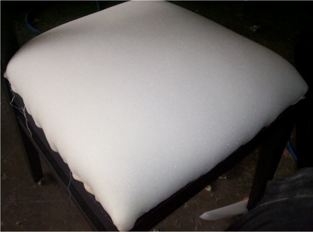
Resim 2.2: Kauçukla yapılmış döşeme dolgusu
