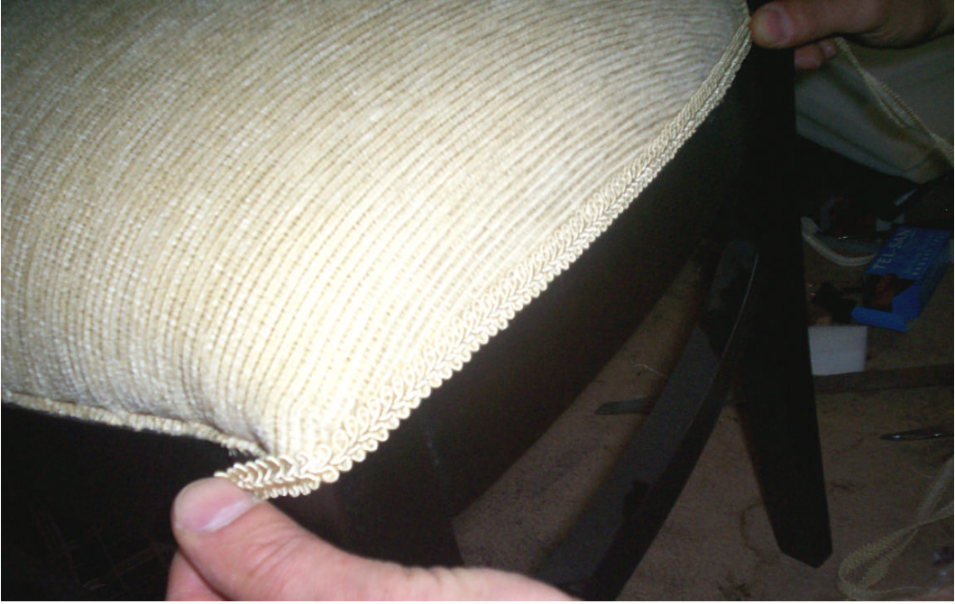
Şekil 2.1: Kumaş bitim yerlerinin şeritle kapatılması
