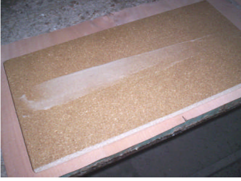
Resim 1. 1: Fazla sürülmüş tutkal
