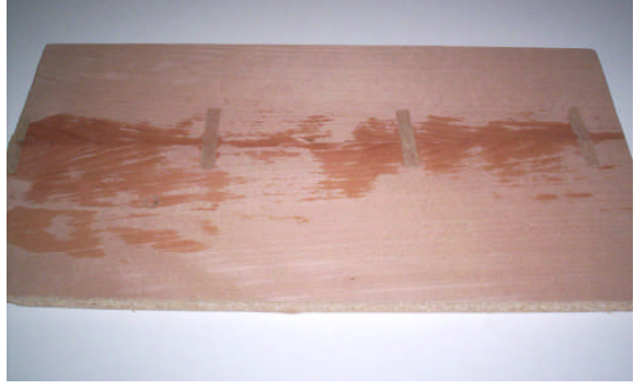
Resim 1. 2: Fazla tutkal sürmenin görüntüsü
