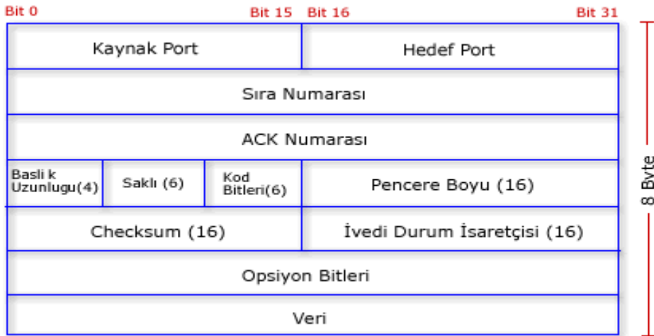
Şekil 1.4: TCP segment formatı
