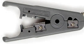
Resim 1.4: Kablo soyma, temizleme ve bükümlü çiftleri ayırma aleti.
