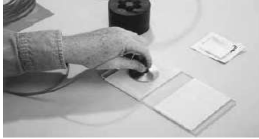
Resim 1.6: Fiber ucunun zımpara pedinin üzerinde düzeltilmesi
