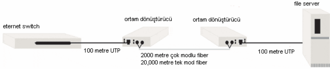
Şekil 2.2: Genel fiber kablo kullanım amacı ve ışığı elektriksel sinyale, elektriksel sinyali ışık sinyale dönüştüren dönüştürücüler
