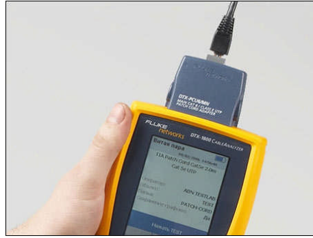
Resim 2.29: Kablunun test edilmesi
